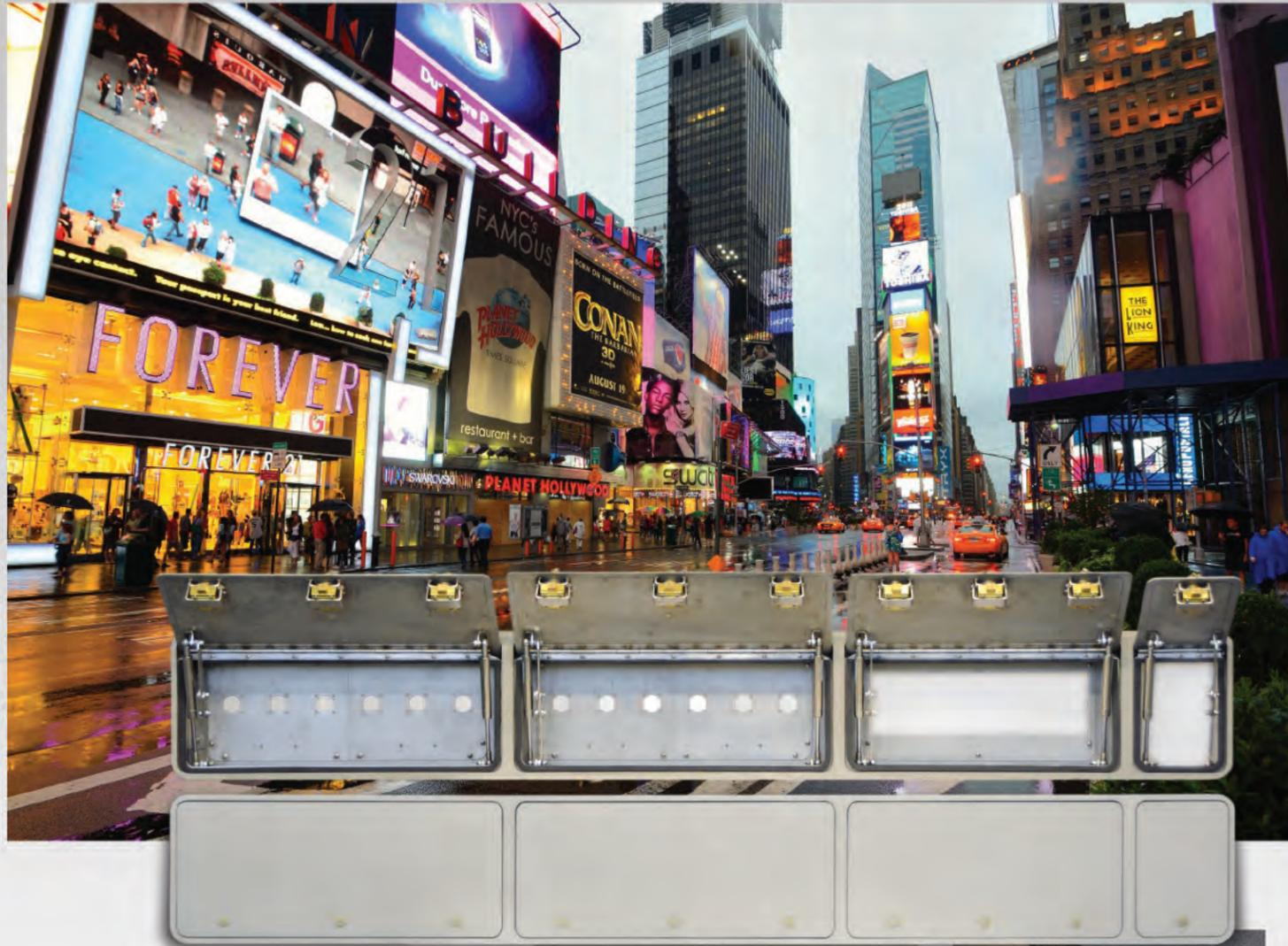
Las puertas Acudor proporcionarán acceso seguro a dichos servicios mezclándose a la vez con su entorno. Estos ensambles para puerta impermeables de compartimentos múltiples operados con puntales de gas son típicamente H33 x L233.7 cm (H13" x L92") fabricados de Acero Inoxidable grado 316 recubierto con Depósito de Flujo de Plasma para mejorar su aspecto. El material específico y expectativas funcionales presentaron retos en ingeniería y manufactura, los cuales fueron enfrentados exitosamente.
