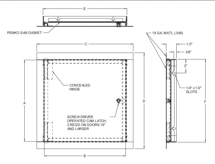
STANDARD FEATURES: SCREW DRIVER OPERATED CAM LATCH, CARBON STEEL, BAKED WHITE PRIME COAT (ADDITIONAL FINISH PAINT IS RECOMMENDED FOR SUPERIOR CORROSION RESISTANCE).
