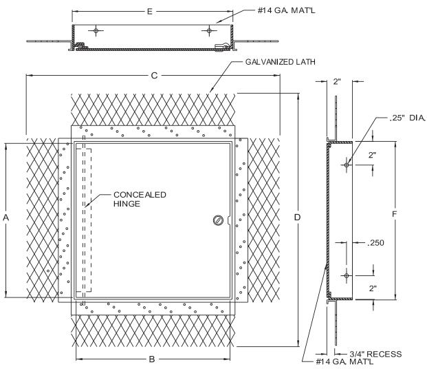
STANDARD FEATURES: STAINLESS STEEL SCREW DRIVER OPERATED CAM LATCH, CARBON STEEL, BAKED WHITE PRIME COAT (ADDITIONAL FINISH PAINT IS RECOMMENDED FOR SUPERIOR CORROSION RESISTANCE).
