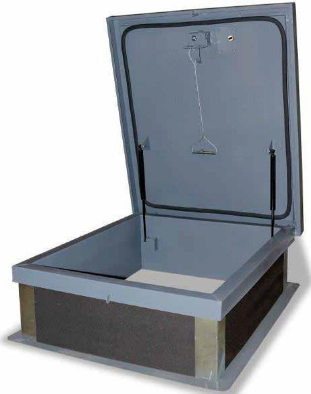
**Cerrojo de la Puerta:** Manija en T exterior de auto-cerrojo, zincada, con ensamble de cerradura interior y palanca de acero inoxidable. Cerradura de detención de uso pesado con llave paracéntrica. La unidad también tiene disposiciones para candado interior y exterior.
