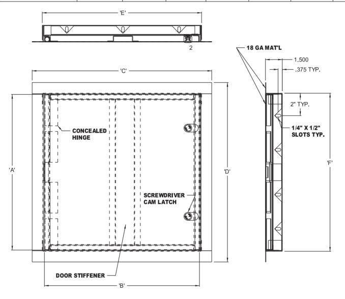
STANDARD FEATURES: SLOTTED SCREW CAM LATCH, CARBON STEEL, BAKED WHITE PRIME COAT (ADDITIONAL FINISH PAINT IS RECOMMENDED FOR SUPERIOR CORROSION RESISTANCE).
