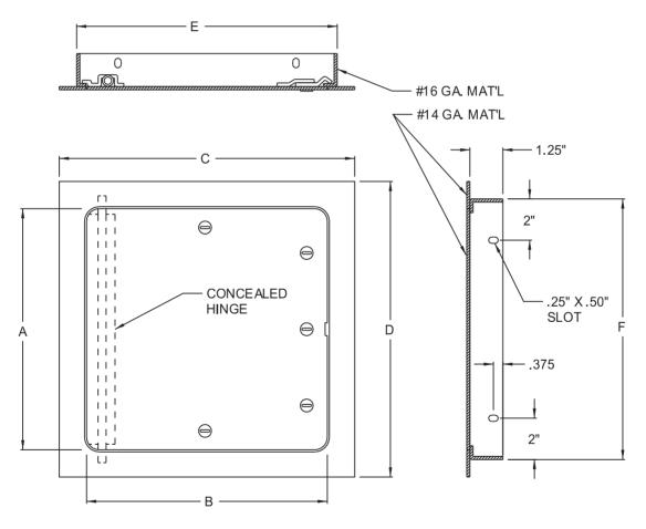
STANDARD FEATURES: SLOTTED SCREW CAM LATCH, CARBON STEEL, BAKED WHITE PRIME COAT (ADDITIONAL FINISH PAINT IS RECOMMENDED FOR SUPERIOR CORROSION RESISTANCE).
